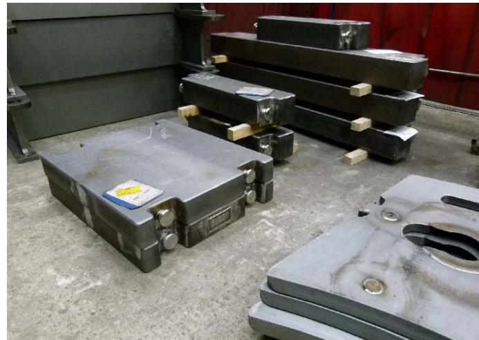
Bild 4: JEBENS, ein ausgewiesener Spezialist für große, schwere Brennteile fertigte für die Taucherglockenanlage die Ballastgewichte und entwickelte mit HAUX auch deren Befestigungselemente.
