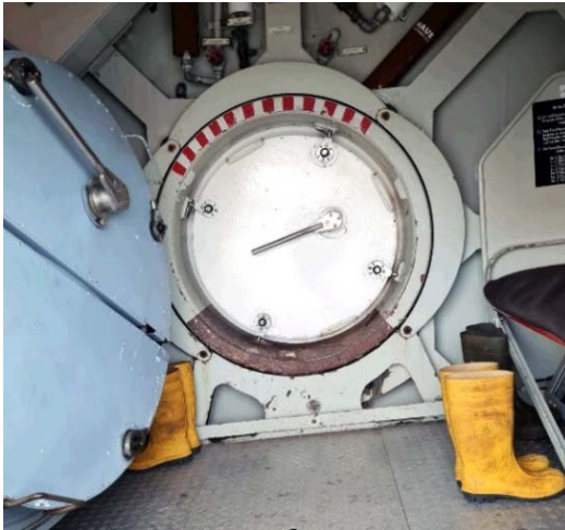
Bild 13: Herzstück des Taucherglockenschiffs – hier das Vorgängermodell Carl Straat – ist die große Taucherglockenanlage mit Druckkammer und Schleusenrohr.
