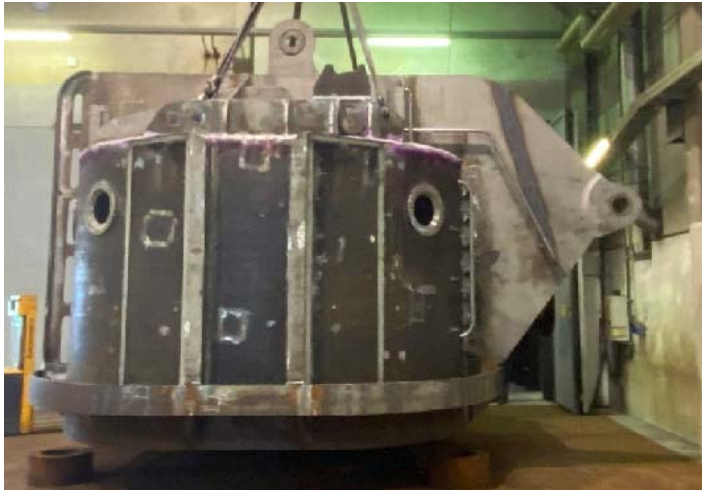
Bild 9: Die neue Taucherglocke – auch Caisson genannt – ist vier Meter lang, sechs Meter breit und 2,7 Meter hoch und für sechs Personen zugelassen.
