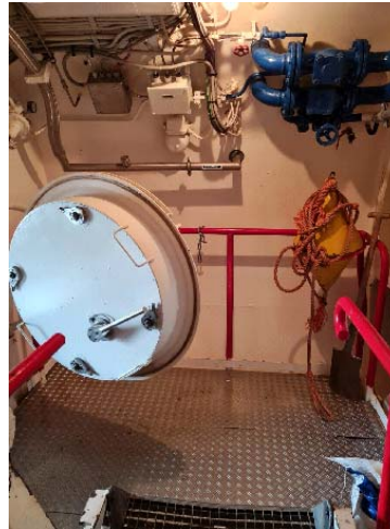
Bild 14-15: Ein- und Abstieg zum Druckraum der Carl Straat, wo die Unterwasserarbeiten stattfinden.
