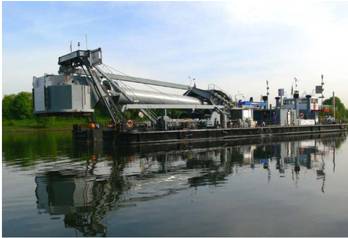
Bild 1: Seit fast 60 Jahren birgt das Taucherglockenschiff Carl Straat verloren gegangene Ladung oder Wracks im Rhein.
