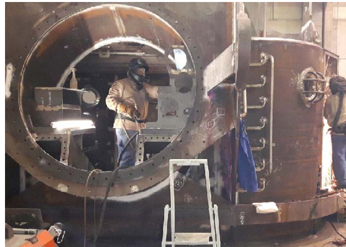
Bild 10: Die neue Taucherglockenanlage hat ein Gesamtgewicht von circa 160 Tonnen und eine Seitentür zum Beladen.
