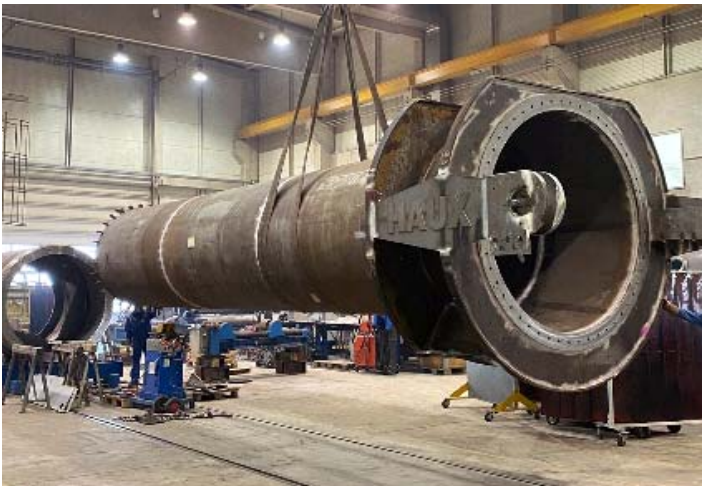
Bild 11: Das 15 Meter lange Tauchrohr verbindet die neue Schleusenkammer über eine lange Treppe mit dem Caisson, jenem Druckraum, wo die Unterwasserarbeiten am Flussbett stattfinden.
