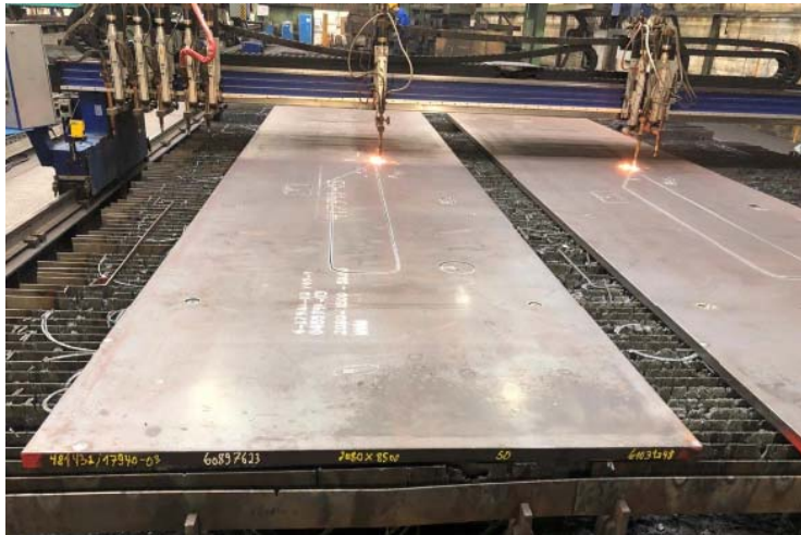
Bild 1: Jebens liefert gebrannte, gerichtete und mechanisch bearbeitete Großbauteile an TRUMPF Machines als Hauptkomponenten der dort gebauten Maschinenkörper.
