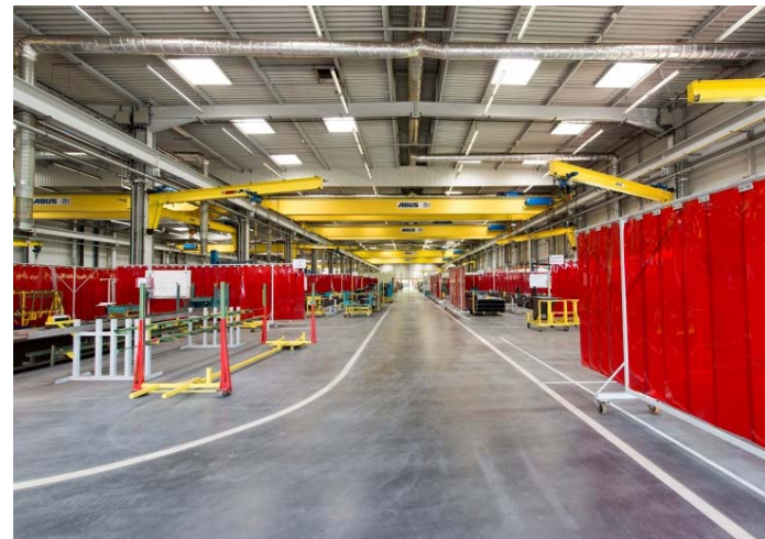
Bild 8: Seit 2004 verarbeitet TRUMPF Machines in Haguenau an sechs aufeinander folgenden Stationen in getakteten Linien die von Jebens gelieferten Brennteile.
