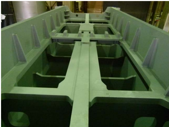
Bild 4: Alle Bereiche, an denen der Stößel mehr Kraft aufnehmen muss, wurden für eine maximale Anbindung besonders stark angefast.
