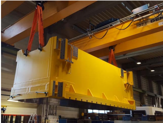
Bild 6: Nach Spannungsarmglühen, Strahlen und Grundieren übernahm Jebens auch den Transport zur anschließenden mechanischen Bearbeitung des Kolosses.
