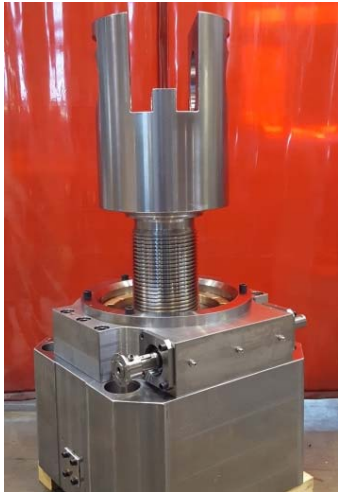
Bild 1: Schweißteil für die Neukonstruktion eines Stößels.
