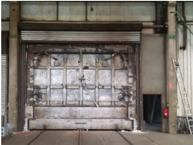
Bild 8: In dem XXL-Glühofen von Jebens wurden die Einzelteile und Komponenten des Pressenstößels geglüht.
