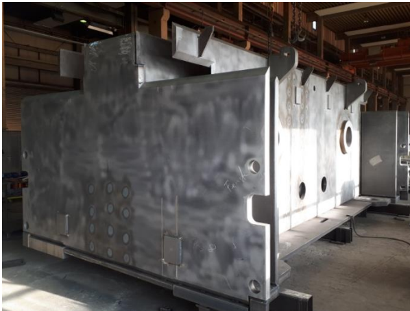
Bild 3: Mit einem Vierwand-Kopfstück – in Längsrichtung zwei äußere und mittig innenliegend zwei weitere Wände mit Wellendurchführung – gewährleistet die Presse höchste Steifigkeit und Genauigkeit.
