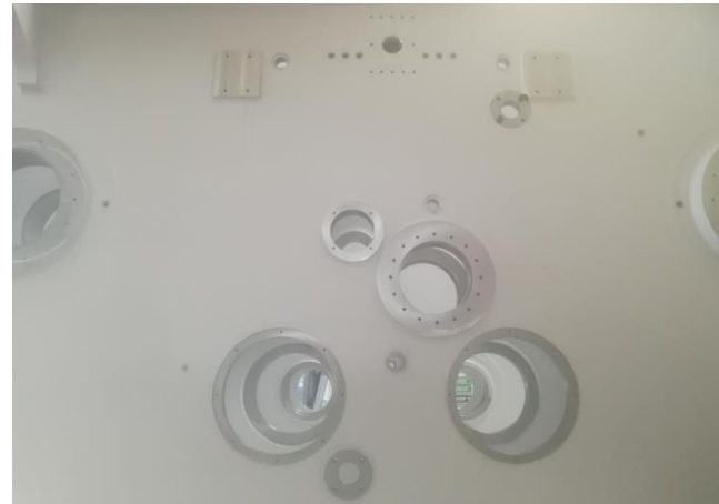
Bild 10: Das exakte Fluchten der Bohrungen musste bis auf ein bis drei Hundertstel genau sein, um die nötige Steifigkeit der Presse zu gewährleisten.
