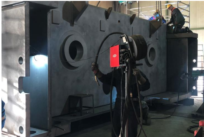
Bild 5: Die hochkomplexen Schweißarbeiten übernahm das Zweitwerk von Jebens in Nördlingen.
