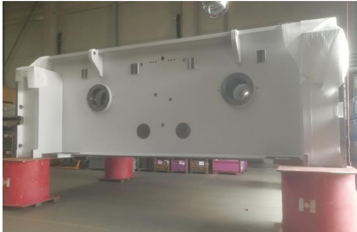
Bild 9: Das fertig lackierte Kopfstück für die 2.500-Tonnen-Pressen bringt 90 Tonnen auf die Waage.
