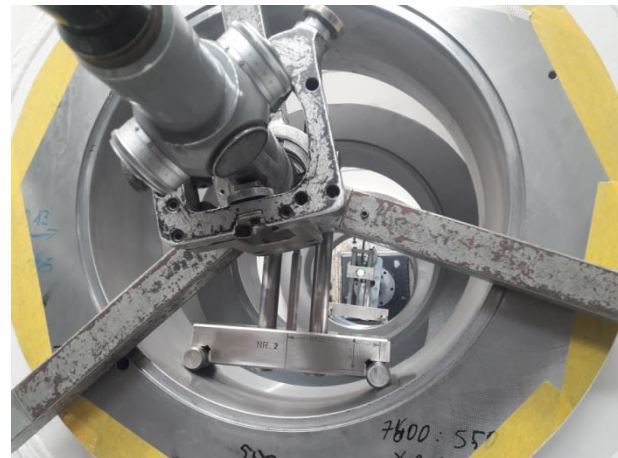
Bild 8: Zylindrizität, Fluchtung und Koaxialität müssen auf ein bis drei Hundertstel genau sein.
