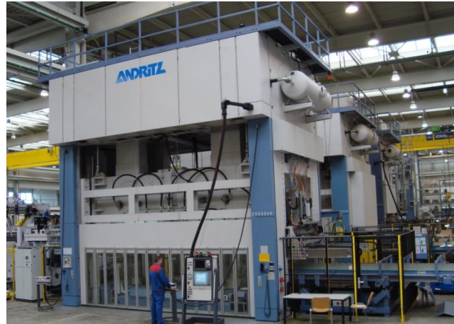
Bild 2: Die 2.500-Tonnen-Pressen vom Typ KSTU4Q 25000-60-15SR aus dem Jahr 2006 war den veränderten Anforderungen nicht mehr gewachsen, weshalb ANDRITZ Kaiser mit dem Retrofitting des Kopfstücks beauftragt wurde.
