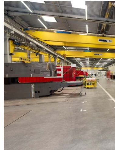
Bild 10: In dieser Zusammenbaustation für kombinierte Stanz-Laser-Maschinen werden bei TRUMPF Machines die von Jebens gefertigten Brennteile zusammengebaut.
