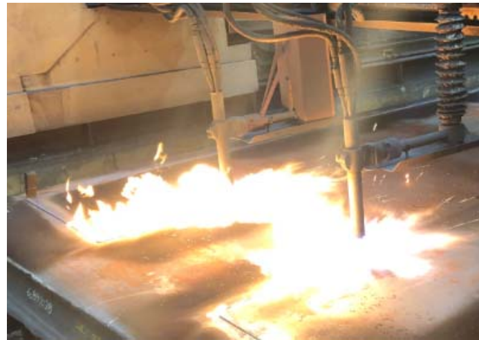
Bild 2: Als Schneidspezialist für Maßarbeit in Stahl erfüllt Jebens die extrem strengen Vorgaben an die geforderte Ebenheit der Brennteile von einem Millimeter von TRUMPF Machines.
