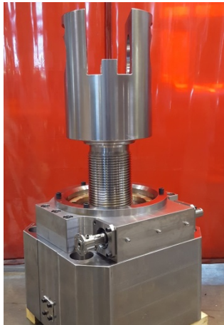
Bild 1: Schweißteil für die Neukonstruktion eines Stößels.
