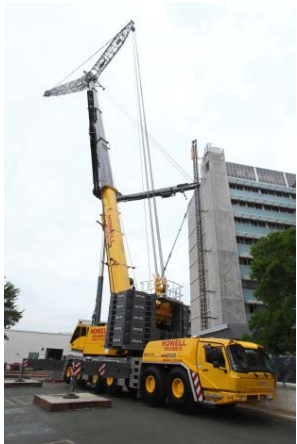
Bild 1-2: Der GMK6400, einer der leistungsstärksten sechsachsigen All-Terrain (AT)-Krane auf dem Markt, wird von Manitowoc gebaut. Die Grundplatte fertigt der Schweißbauspezialist Jebens GmbH.
