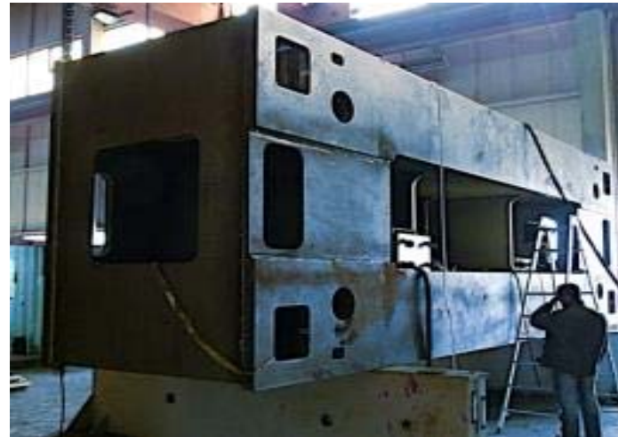
Bild 10: Jedes Pressengestell besteht aus je einem oberen und unteren Querhaupt, die mit vier Zugankern und Ständern miteinander verschraubt und vorgespannt werden.
