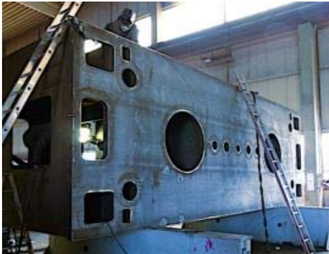
Bild 9: 62 Tonnen wiegt dieses von Jebens gefertigte obere Querhaupt für Dieffenbacher.
