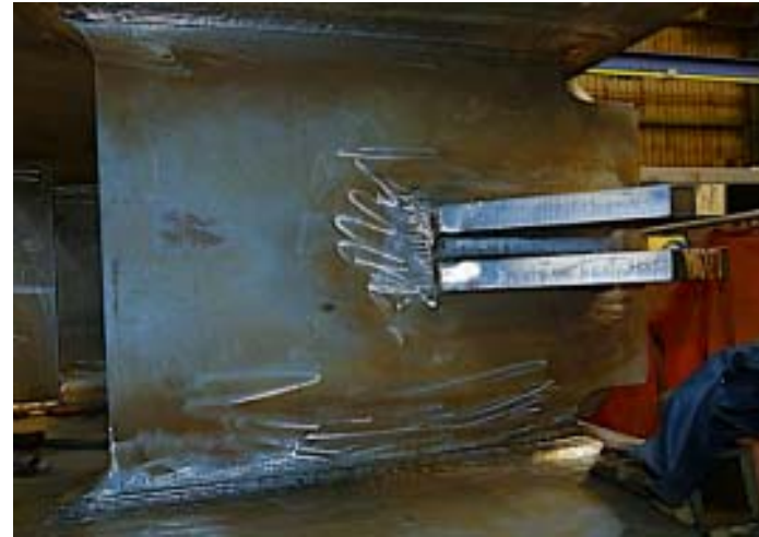
Bild 2: Kleine, filigrane Bauteile werden passgenau und fachgerecht eingeschweißt.
