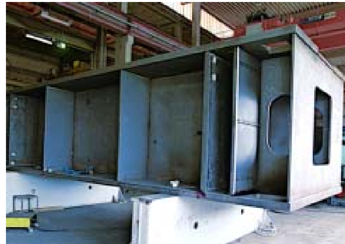
Bild 12: Das obere Querhaupt ist mit einem Gewicht von 62 Tonnen eine der schwereren Baugruppen aus den Stahlgüten S235JR oder S355J2.
