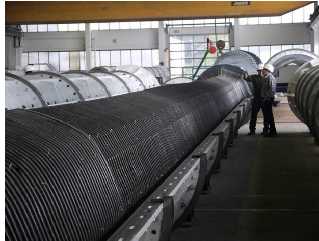
Bild 6: Das anspruchsvolle Herstellungsverfahren des Schleuderbetons gewährleistet die in Algier geforderte Größe, Belastbarkeit, Funktionalität und Optik.
