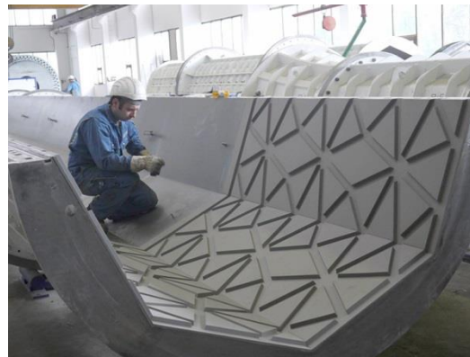
Bild 4: Die sternförmigen Reliefs der Moscheesäulen werden beim Schleuderprozess direkt mit geformt.
