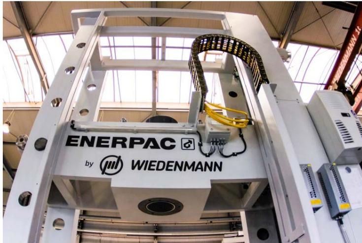
Bild 6: Das Oberjoch ist elektromechanisch in fünf Stufen à 400 Millimetern über Spindeltriebe und Bedienpaneele verstellbar.
