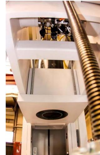
Bild 8: Der mittig im Oberjoch montierte Hydraulikzylinder verriegelt sich selbstständig auf der neuen Position.
